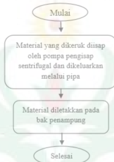
Gambar 5.3 Pelaksanaan Pekerjaan Penggalian Ke Darat Menggunakan Kapal Keruk Cutter Suction Dredger (CSD)
