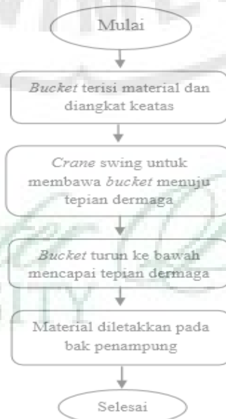
Gambar 5.2. Pelaksanaan Pekerjaan Penggalan Ke Darat Menggunakan Kapal Keruk Clamshell .
