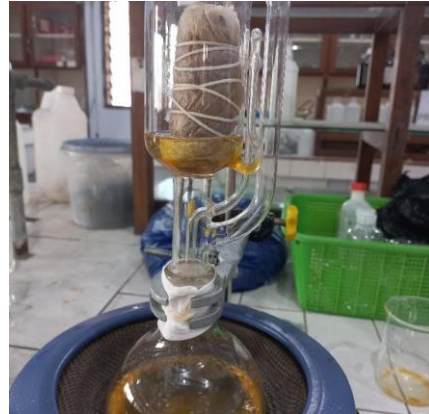
6. Perubahan warna pelarut menjadi kuning kecoklatan bahwa sampel telah terekstrak
