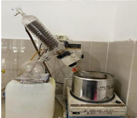
7. Sampel yang bercampur dengan pelarut di uapkan dengan rotary evaporator selama 3 jam
