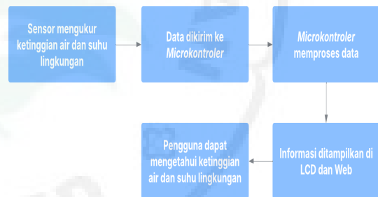
Gambar 3. Diagram alur rancangan sistem
