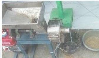
**Gambar 4.** Mesin TTG Penggiling Rempah
