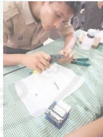
Gambar 2. Proses Pemotongan Pelindung Dalam Kabel Fiber Optik
