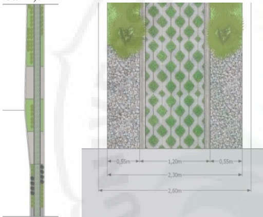
Gambar 1. Rancangan Ukuran Lebar Jalan Desa.
