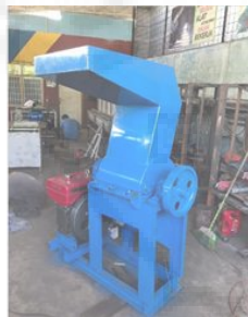
Gambar 5. Alat Pencacah Plastik Jenis Kapasitas 250 kg/jam.
