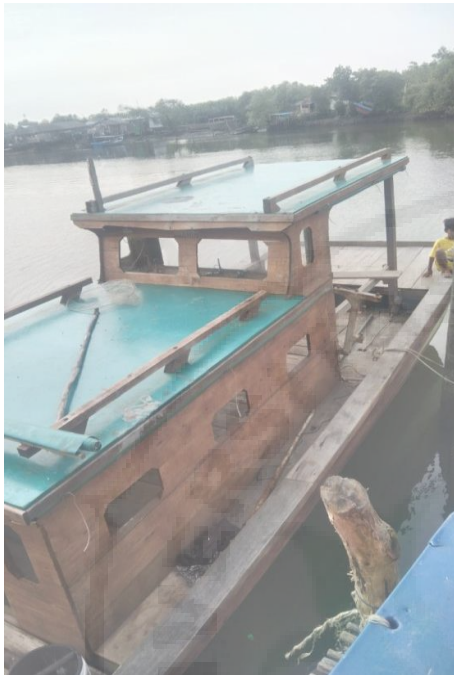
Gambar 2. Bagian Atas Kapal Yang Akan Dipasang Solar Panel.
