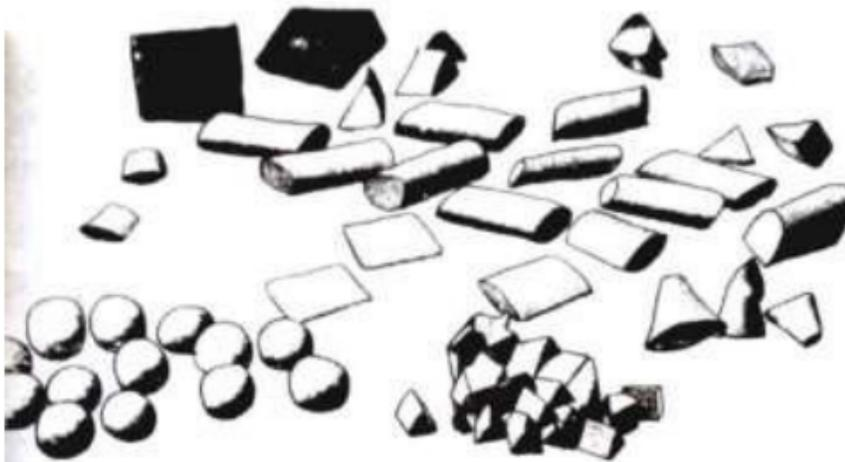
**Gambar 5.6.** Bentuk-bentuk media pembersih/poles untuk pengerjaan barrel
