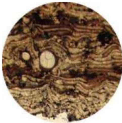
Gambar 5.14. Pelapisan spraying komposit Cu-Al dengan pengumpanserbuk.
