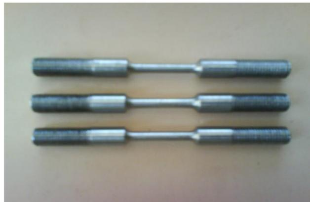
**Gambar 13.** Spesimen Uji Tarik Statis
