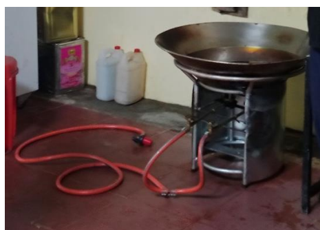
Gambar 8. Hasil Rancang Bangun Penggorengan Stainless dan Tungku
