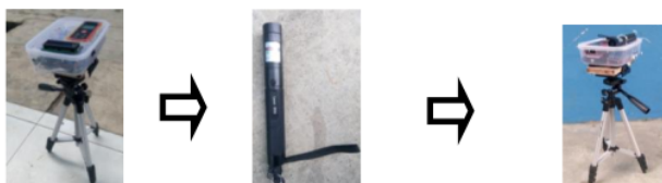
Gambar 5. Digital Distance Meter, Laser, Digital Distance Meter yang dimodifikasi dengan penambahan laser yang lebih terang
