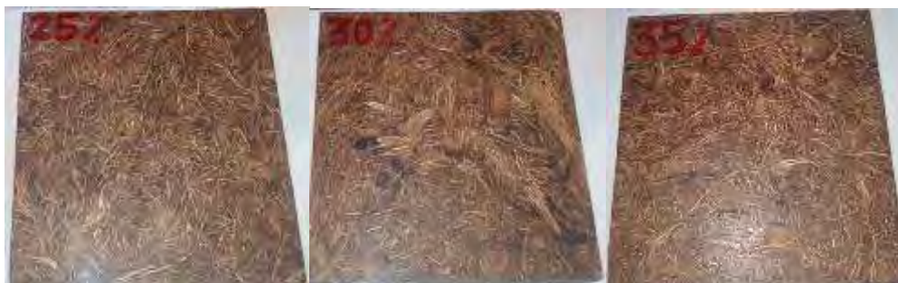
Gambar 2. Papan Partisi Komposit Polimer pengisi Serat TKKS
