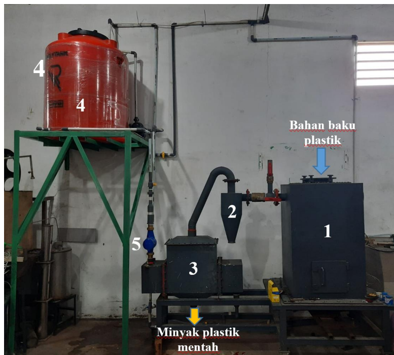
Gambar 7. Sistem pirolisis bahan plastik menjadi bahan bakar: (1) Reaktor pirolisa, (2) Cyclone, (3) Kondensor, (4) Tangki air pendingin kondensor, dan (5) Meteran kelajuan air pendingin
