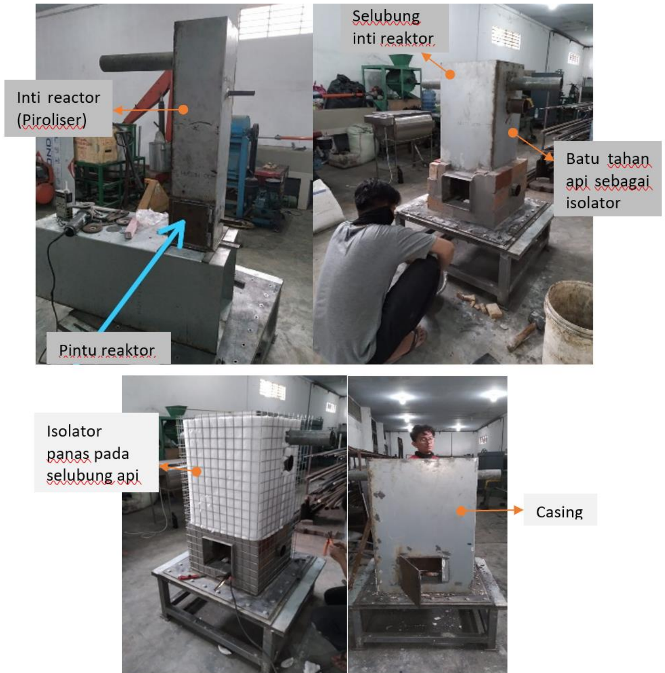
Gambar 3. Desain dan fabrikasi reactor pirolisa
