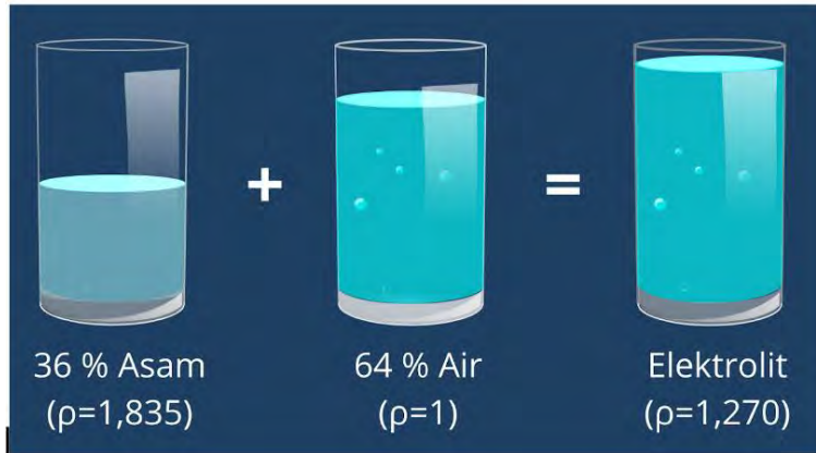
Gambar 5.10 Skema perbandingan larutan elektrolit pada aki
