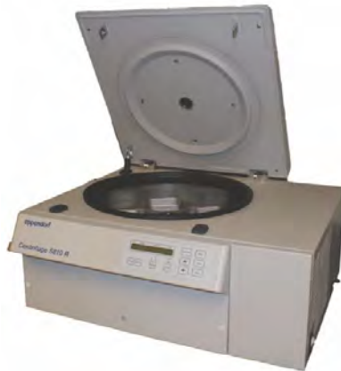
Gambar 2.4 Bench-top centrifuge mampu mencapai kecepatan hingga 14000 rpm dan gaya sentrifugal 20800\times g . Centrifuge khusus ini dapat didinginkan, memungkinkan sampel didinginkan hingga suhu -4^{\circ}\text{C} .
