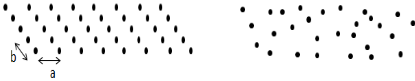
Gambar 4.1. Ilustrasi susunan atom pada kristal (kiri) dan amorf (kanan)
