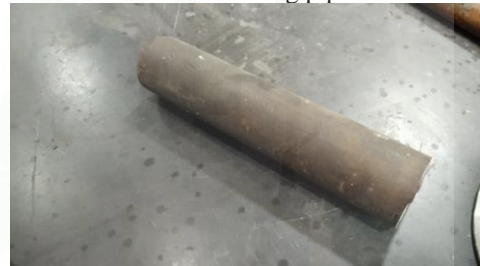
Gambar 6. Pipa besi boss untuk penyangga tuas
