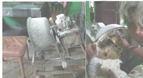
Gambar 1. Prutan yang digunakan saat ini (parutan kelapa)
