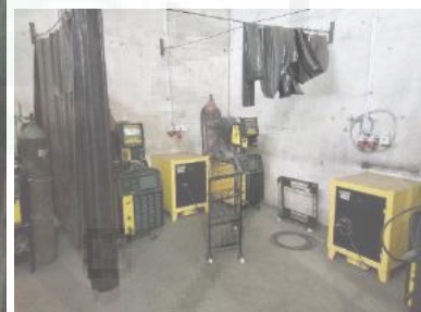
Gambar 3.7 Bangsal/Sel tempat praktek mengelas dan beberapa mesin las SMAW yang digunakan dengan kapasitas 300 Ampere (luas 4x15 m 2 )
