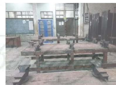
Gambar 3.8 Ruang Bangsal/Sel tempat praktek mengelas dan beberapa mesin las MIG dan TIG meja kerja serta peralatan ragum yang digunakan dalam pengelasan (luas 4x8 m 2 )
