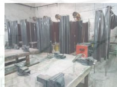
Gambar 3.8 Ruang Bangsal/Sel tempat praktek mengelas dan beberapa mesin las MIG dan TIG meja kerja serta peralatan ragum yang digunakan dalam pengelasan (luas 4x8 m 2 )
