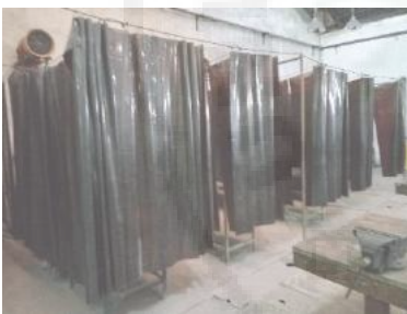
Gambar 3.7 Bangsal/Sel tempat praktek mengelas dan beberapa mesin las SMAW yang digunakan dengan kapasitas 300 Ampere (luas 4x15 m 2 )
