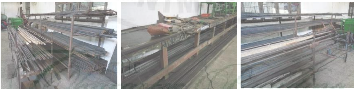
Gambar 3.11 Ruang tempat penyimpanan bahan untuk pengelasan, beberapa besi siku, pelat, besi olo, besi petak, pelat besi, dll, (luas 4x10 m 2 )
