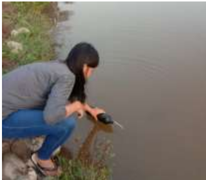
Pengambilan air untuk mengukur kekeruhan dan kadar oksigen terlarut (DO)
