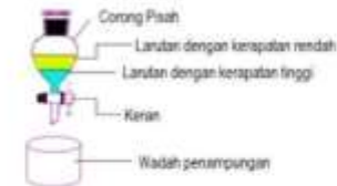
Gambar 3.1 Skema Pemisahan Ekstraksi Cair – Cair Sumber : http://google.com/image
