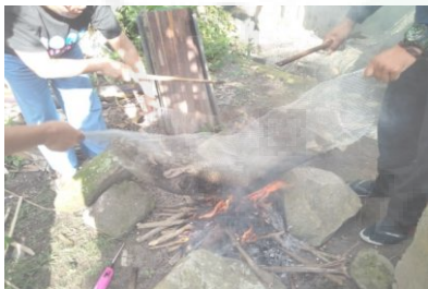
Gambar 6. Pengarangan tempurung kemiri
