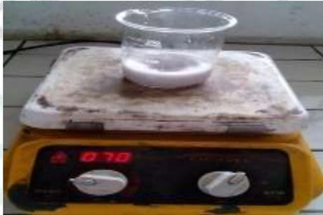
**Gambar 2.4.** Campuran Abu Sekam Padi dengan HCl 2 M
