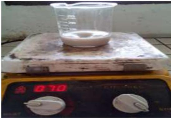
**Gambar 2.8.** NaOH dimasukan kedalam dalam Larutan Abu Sekam Padi yang telah bercampur dengan PEG 6000
