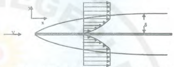
Gambar 1. Lapis batas kecepatan pada plat dengan aliran paralel
