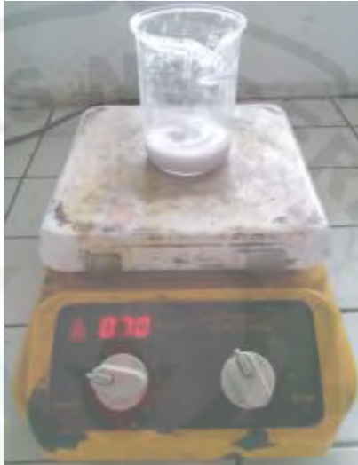
Gambar 2.12. Penambahan Abu Sekam Padi ke dalam Larutan PEG-6000
