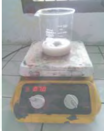
Gambar 2.6. NaOH Dimasukkan ke dalam Larutan Abu Sekam Padi
