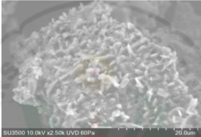
Gambar 3.9. Morfologi Abu Sekam Padi dengan PEG-6000 1:5
