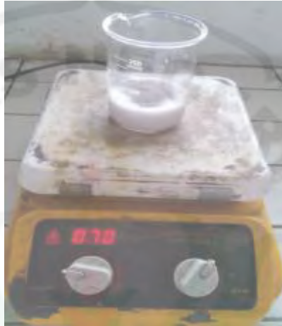
Gambar 2.4. Campuran Abu Sekam Padi dengan HCl 2 M
