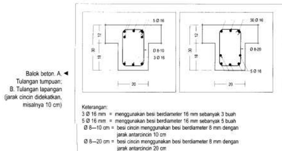
**Gambar 3.3. Gambar Tulangan Balok Beton**
