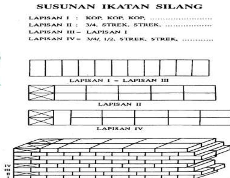
**Gambar 4.3. Susunan Ikatan Silang**
