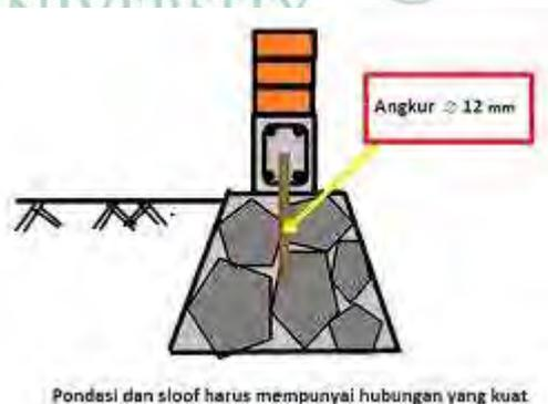
**Gambar 2.14. Hubungan Antara Pondasi Dengan Sloof**
