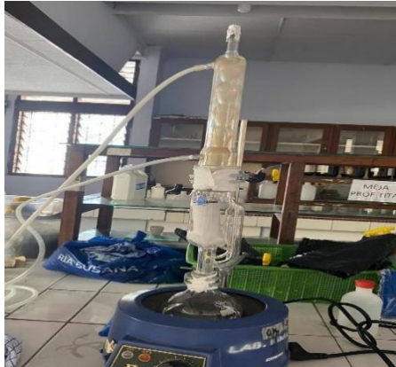
5. Ekstraksi minyak atsiri cascara dengan metode soxhletasi selama 6 jam
