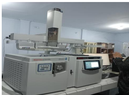
1. Alat GC-MS untuk mengidentifikasi senyawa fitokimia pada minyak atsiri cascara
