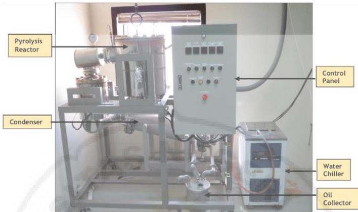
Gambar 3. 2. Batch reaktor (Miandad *et al.*, 2006)
