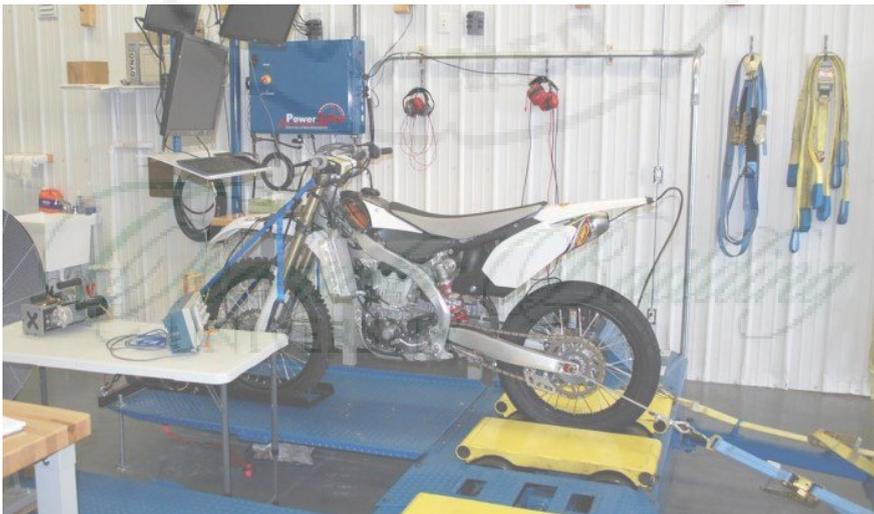
Gambar 3. 7. Uji performa sepeda motor dengan BBM pirolisis campuran bensin (Fortuna Motor, 2022)
