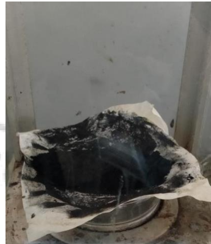
Gambar 10. Hasil pengeringan karbon aktif dengan oven
