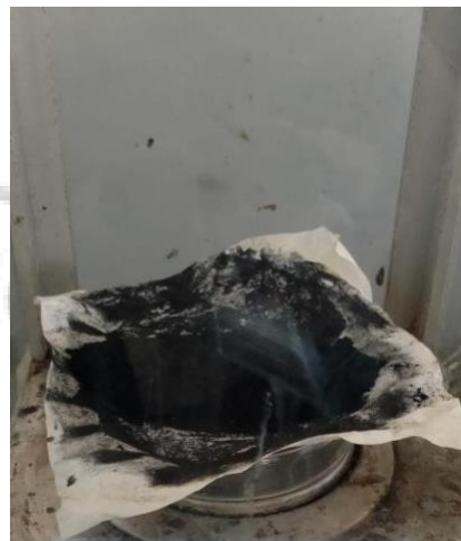
Gambar 2. Hasil pengeringan karbon aktif dengan oven
