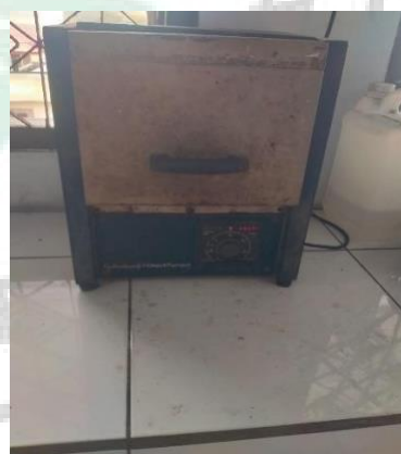
Gambar 6. ditanur selama 2 jam pada suhu 400°
