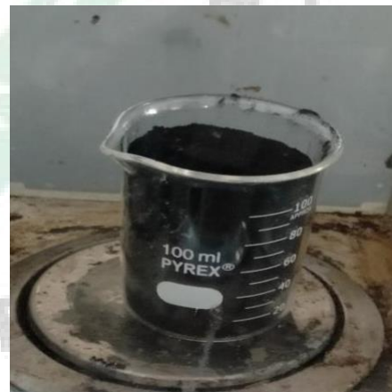
Gambar 12. Hasil KA HDTMA-Br yang sudah dioven
