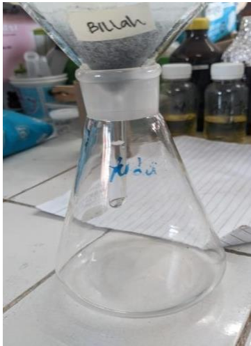
Gambar 9. Hasil filtrat karbon yang sudah netral
