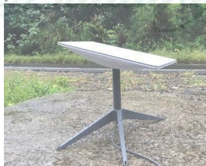
Gambar 5. Modul penerima internet satelit "Starlink".
