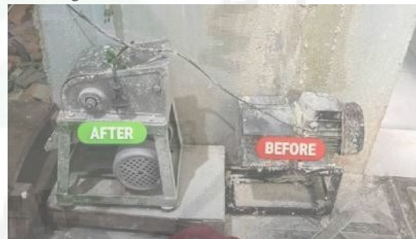
Gambar 12. Mesin Penggiling besar lebih efisien dalam menggiling Ubi
