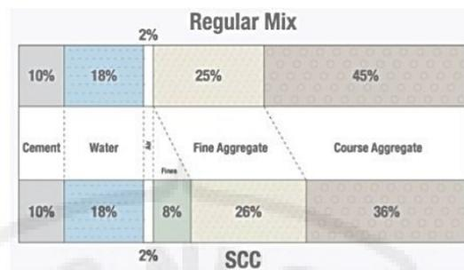
Gambar 2. 2 Perbandingan Proporsi Campuran SCC dengan Beton Konvensional (Sumber : Okamura dan Ouchi, 2003)
