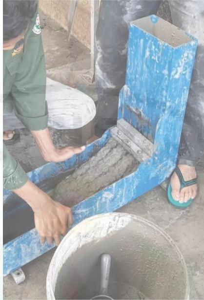
Gambar 3. 22 Pengujian L-Box
