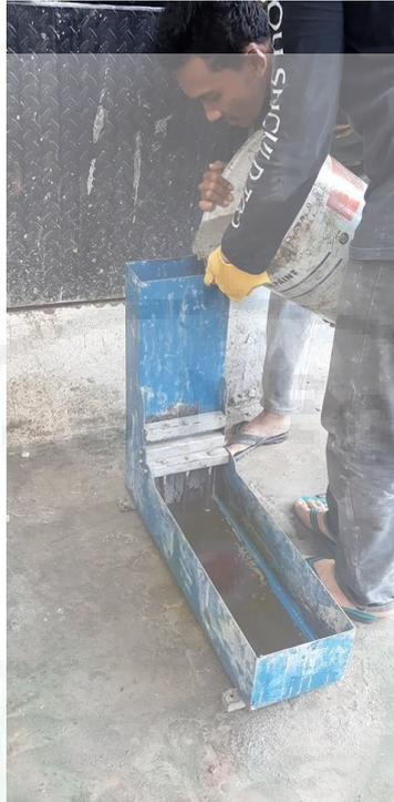
Gambar L.5 Melakukan Pengujian L-Box
