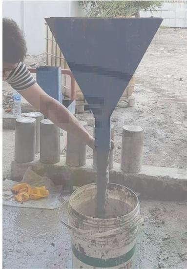
Gambar 3. 21 Pengujian Viskositas
