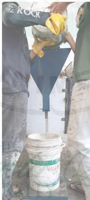
Gambar L.4 Melakukan Pengujian V-Funnel
