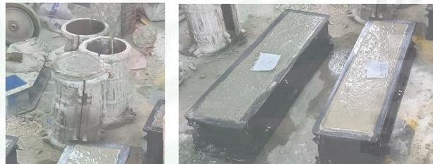
Gambar 3. 15 Cetakan Benda Uji
