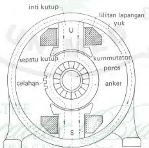
Gambar 2.10 Struktur motor DC (Sumber : Cendana,2018)
