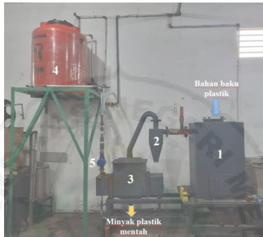
Gambar 29. Sistem minimal proses pirolisis sampah plastik
