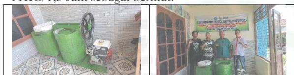
**Gambar 4.** Mesin Rotasi Untuk Produksi Es Podeng Dengan Sistem Rotasi yang telah dikembangkan.
