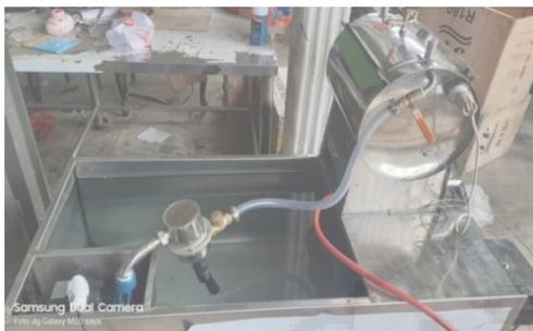
**Gambar 1.** Mesin *Vacum Frying* Untuk Memproduksi Keripik Nanas.
