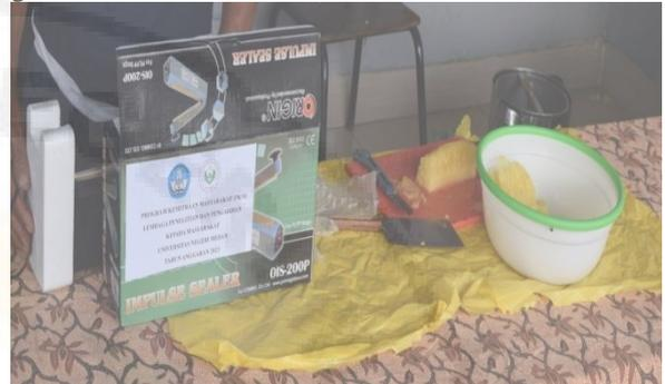
**Gambar 10.** Mesin *Impulse Sealer*.
