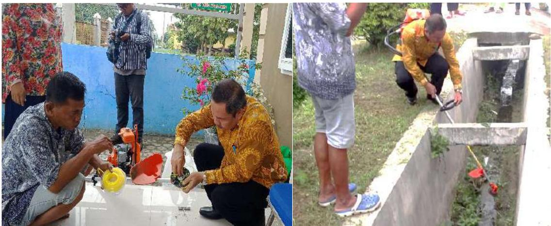
Gambar 5.12. Proses demonstrasi penggunaan alat pembersih drainase dengan memodifikasi mata mesin pemotong rumput gendong.
