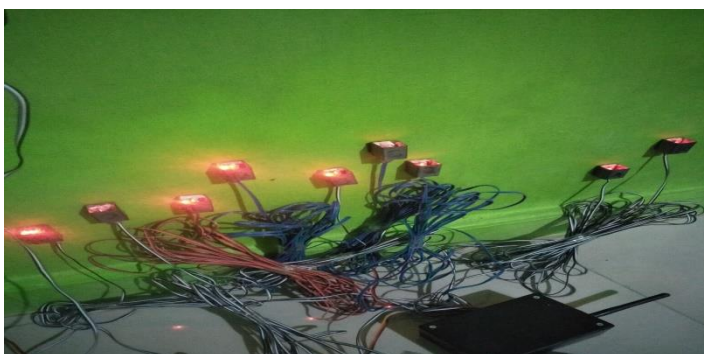
Sensor Getar Dengan Lampu Menyalakan Terhubung Dengan Alat Arduino Promini
