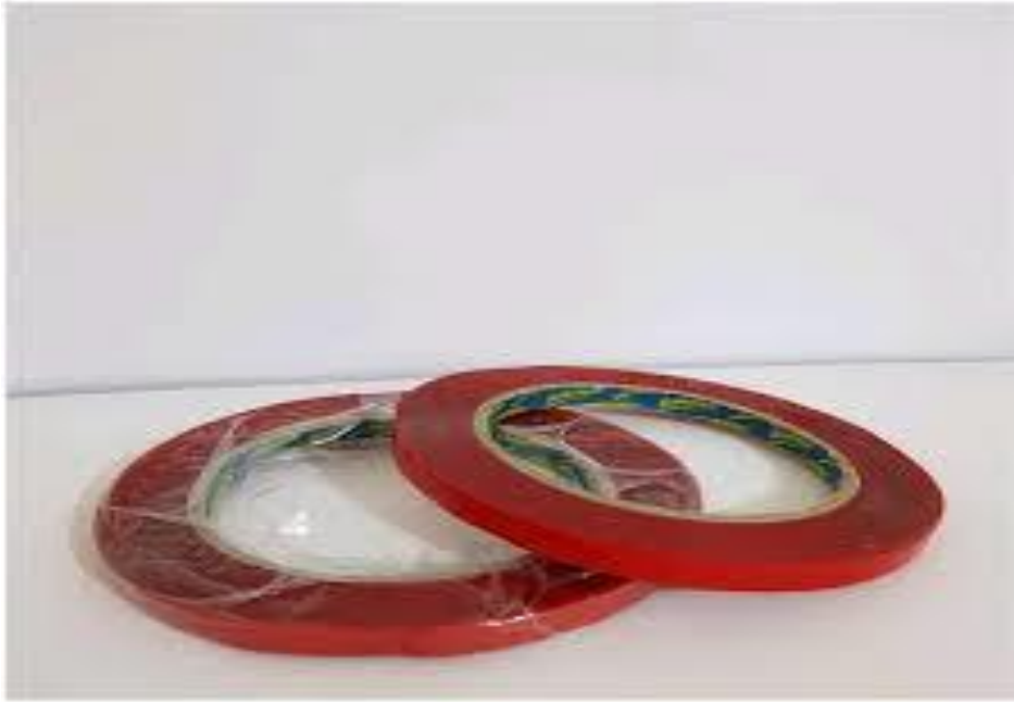
Gambar. Double Tip Untuk Menempelkan Setiap Sensor Getar Dibelakang Terpal Pada Masing-Masing Angka Sasaran Shooting .
