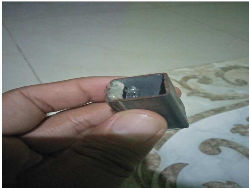
Gambar Sensor Getar Setelah Dilindungi Dengan Plat Besi.
