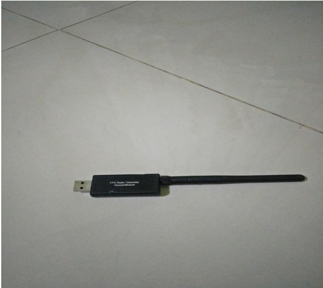
Gambar Modul Radio 3dr Alat Penerima Data Hasil Shooting Yang Terhubung ke Laptop
