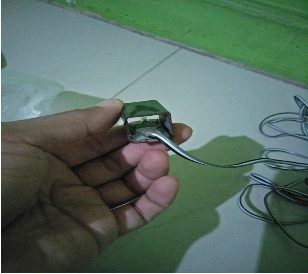
Gambar Sensor Getar Dilindungi Dengan Plat besi Terhubung Dengan Kabel Pada Alat Arduino Promini
