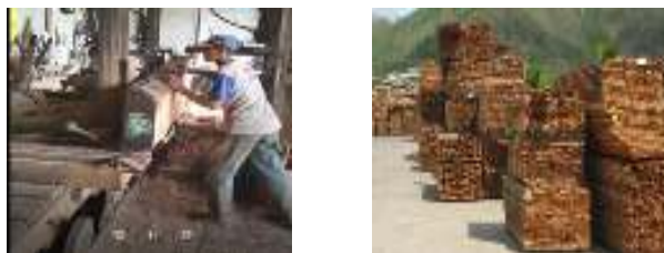
Gambar 2.5. Mesin Gergaji Pita ( Bansaw ) dan Kayu yang dihasilkan
