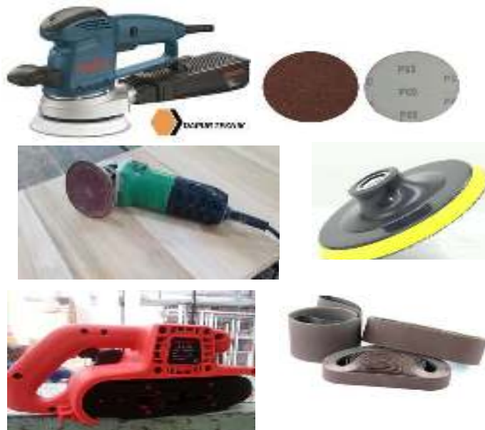
Gambar 6.10. Model mesin amplas dan model amplas
