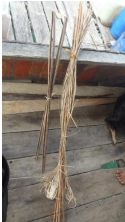
Tulang daun kelapa dan rotan yang digunakan sebagai bingkai kajang Sumber: Dokumentasi pribadi
