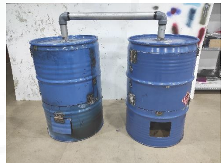
Gambar 5.4. Drum pengasapan ikan sistem paralel
