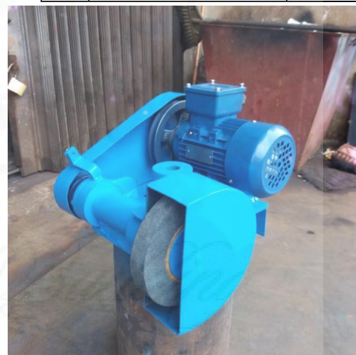
Gambar 5. Mesin Gerinda Toolpost Hasil Rancang Bangun
