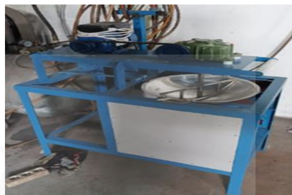
Gambar 4. Alat Pengaduk Bandrek Instan.
