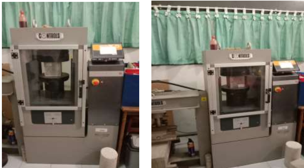
Gambar 11. Pengujian Kuat Tekanan
