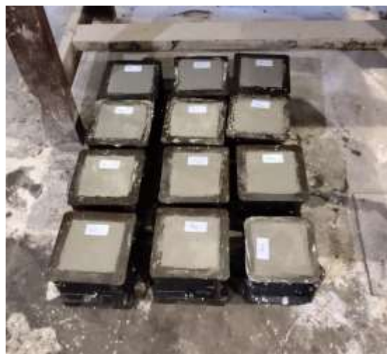
Gambar 6. Cetakan dikeringkan selama 24 jam
