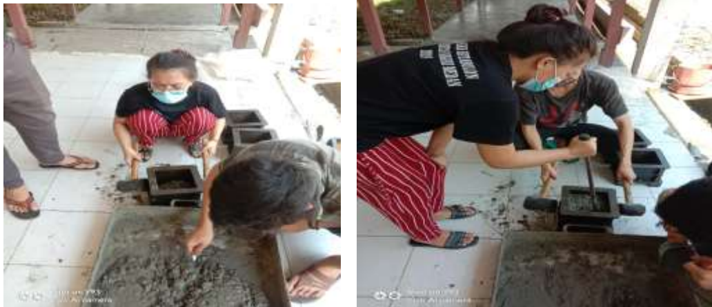
Gambar 4. Campuran dimasukkan kedalam cetakan
