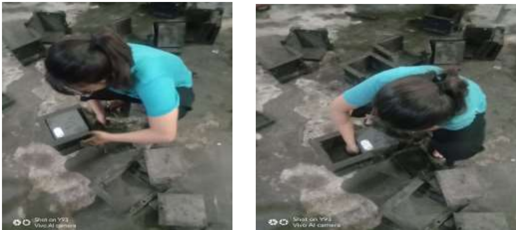
Gambar 7. Beton yang sudah dikeringkan selama 24 jam dikeluarkan dari cetakan berbentuk kubus
