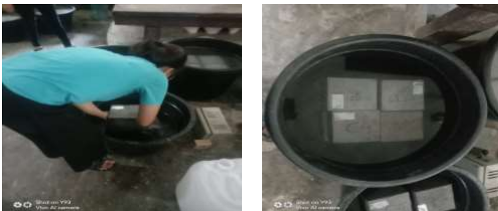
Gambar 8 . Perendaman Sampel pada air biasa dan air belerang
