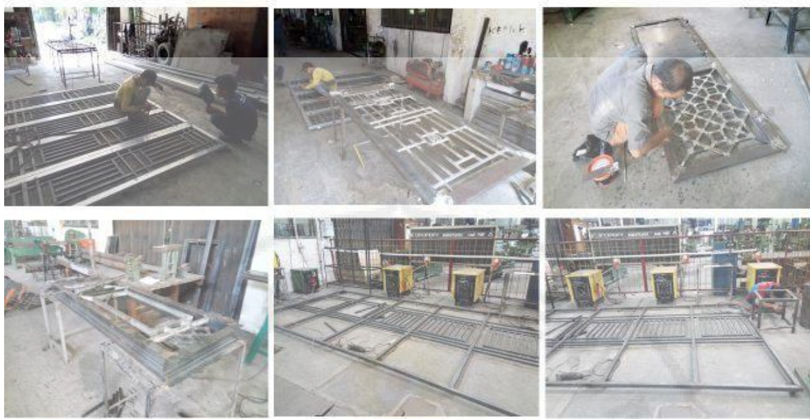
Gambar 4.5 Proses pengerjaan berbagai jenis produksi las fabrikasi logham di bengkel teknik Unimed
