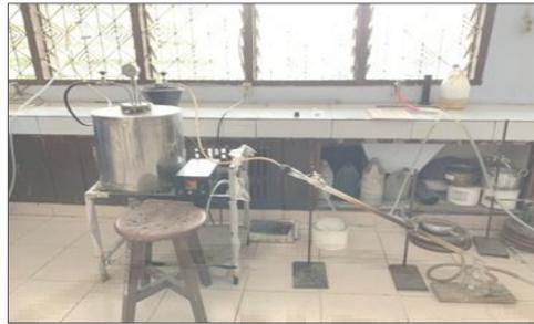
Gambar 1. Skema reaktor proses pirolisis dengan laju pemanasan  $45^{\circ}\text{C}/\text{menit}$
