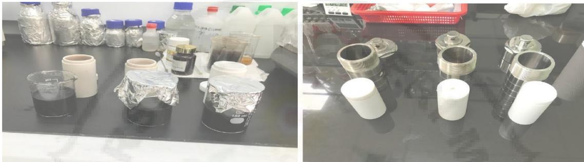
**Gambar 5. Proses Hidrotermal**
