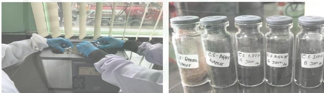
**Gambar 6. Proses Ultrasonikasi dan produk Sampel CS1, CS2, CS4, CS6, CS8**
