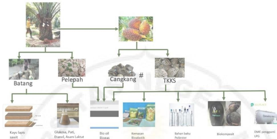
Gambar 1. Pemanfaatan Limbah Padat Kelapa Sawit [2]
