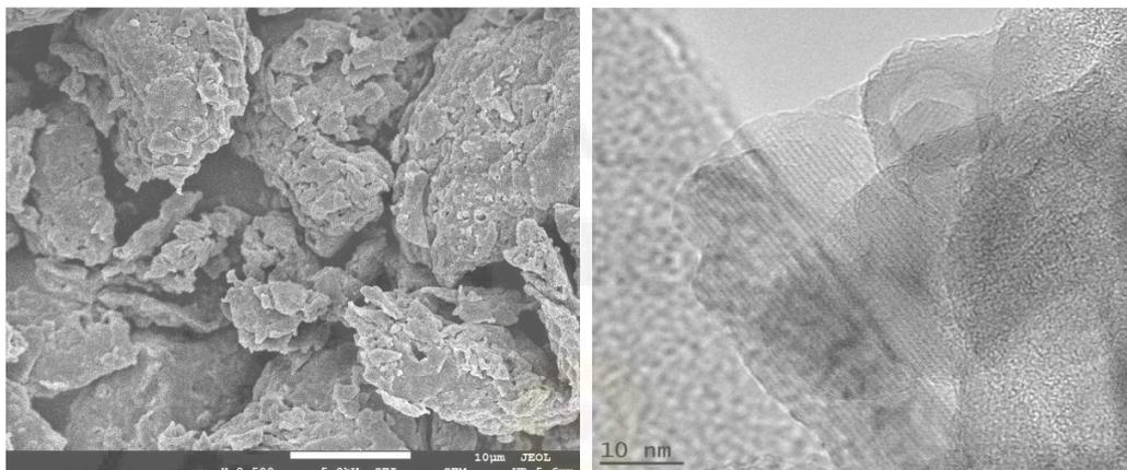
**Gambar 9.** Foto SEM dan TEM Nanokarbon Cangkang Sawit (CS6)
