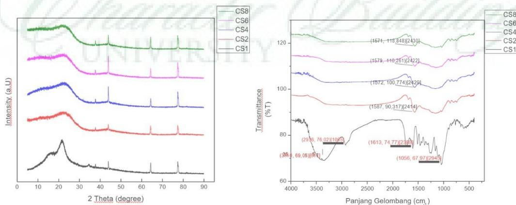
**Gambar 8. Difraktogram X-RD dan FTIR Nanokarbon Cangkang Sawit**
