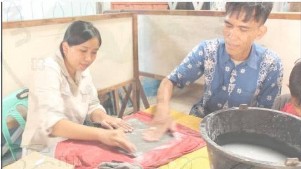
Tahap mengamplas resin yang mengeras dengan amplas no 1000
