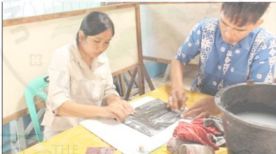
Tahap mengamplas resin yang mengeras dengan amplas no 600
