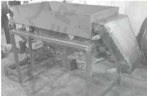
Gambar 2. Rancangan Ayakan Limbah Arang Tempurung Kelapa Sistem Ayun
