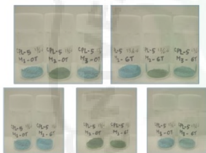
Gambar 7. Kristal CPL-5 disintesis pada 25°C, 0T dan 6T untuk semua metode.
