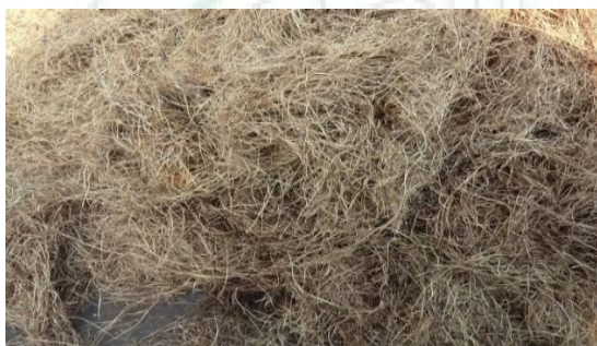
Gambar 5. TKKS terurai pada putaran 1200 rpm
