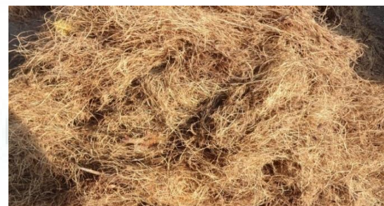
Gambar 8. TKKS terurai pada putaran 1350 rpm
